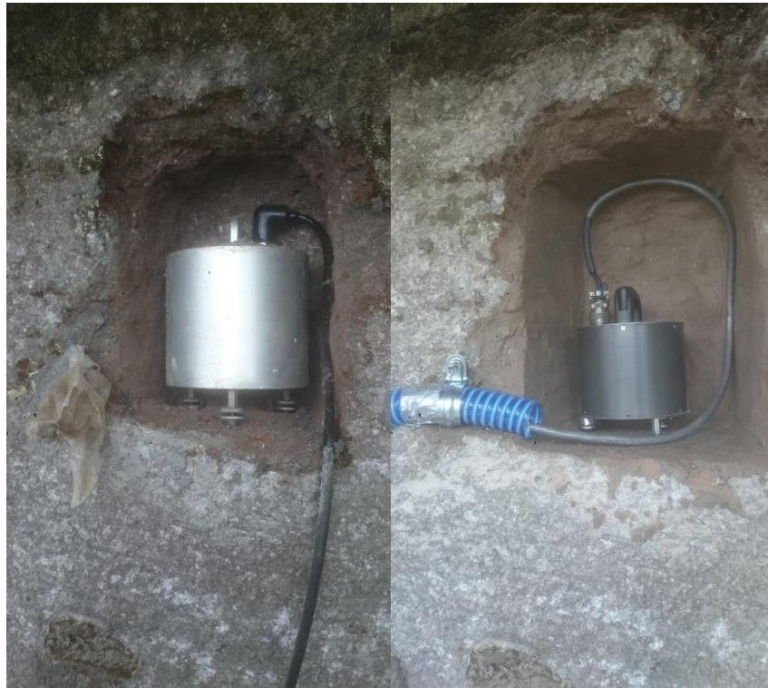
Figura 99. Sismómetro de corto periodo pasivo (izquierda) y sismómetro de corto periodo activo (derecha) en la estación multiparamétrica CERRO BRAVO.
