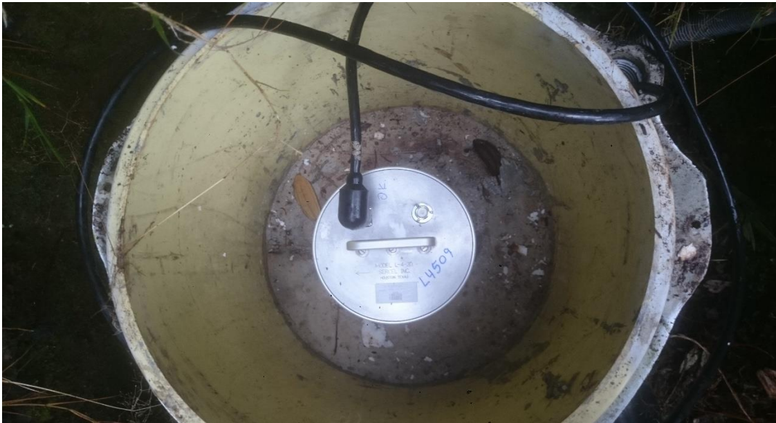
Figura 98. Nuevo sismómetro de la estación LA SIBERIA.
