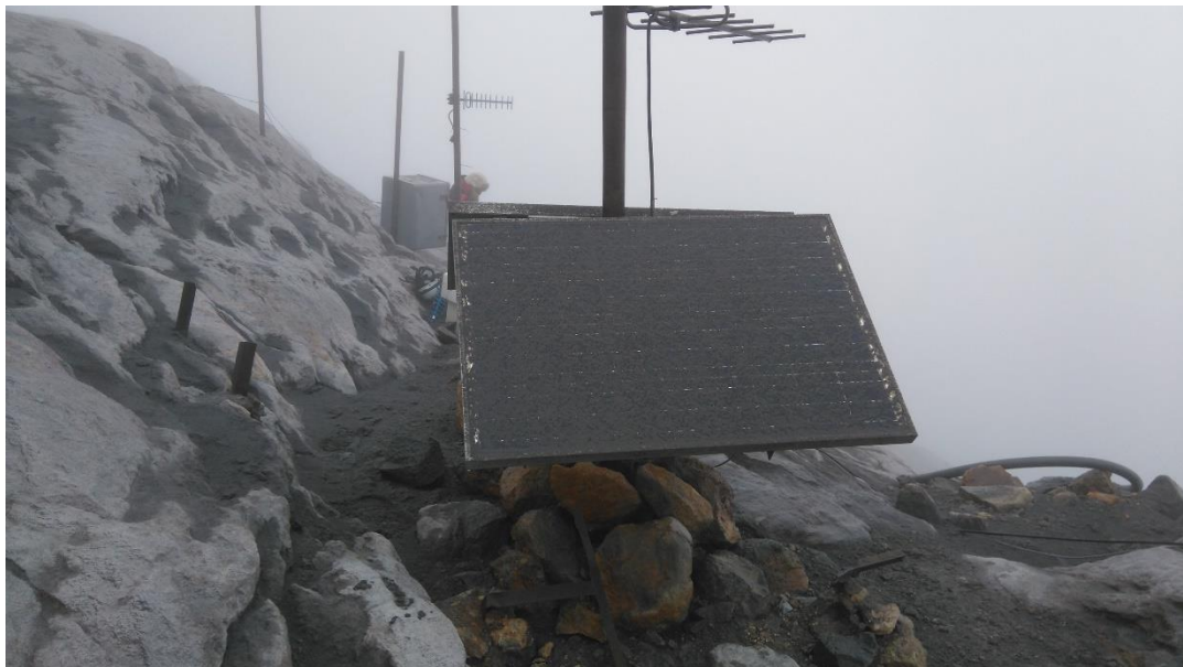
Figura 5. Estación sismológica BIS con ceniza en sus paneles solares.
