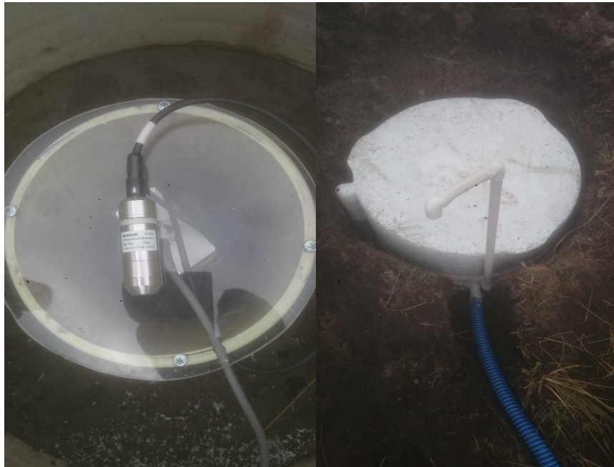
Figura 17. Sensores acústicos de infrasonido instalados en la estación multiparamétrica RUBI.
