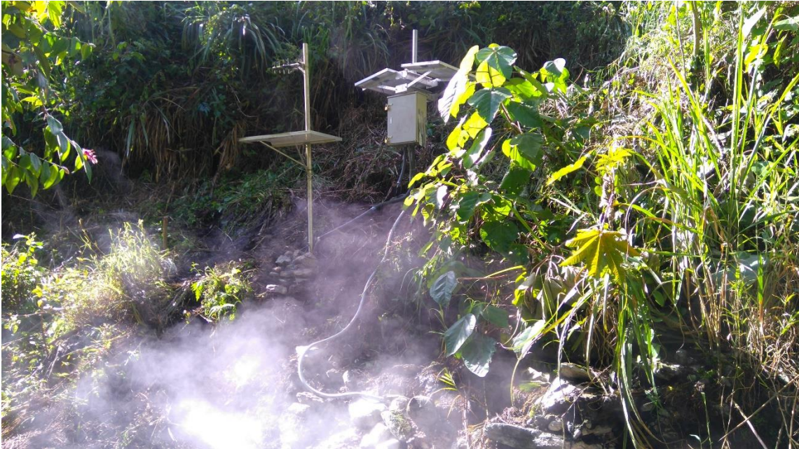
Figura 75. Estación de medición de temperatura de aguas termales ESTATUAS.
