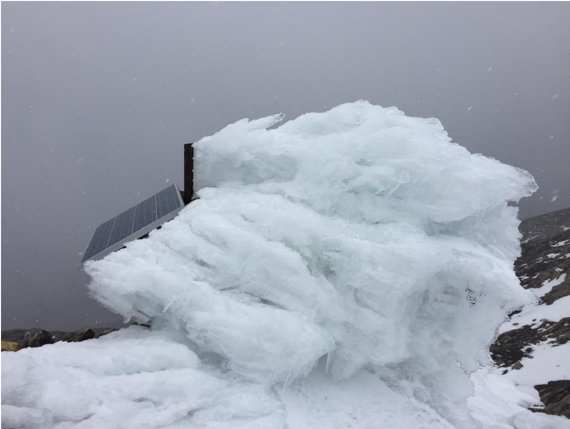
Figura 10. Acumulación de hielo en la estación sismológica BIS.
